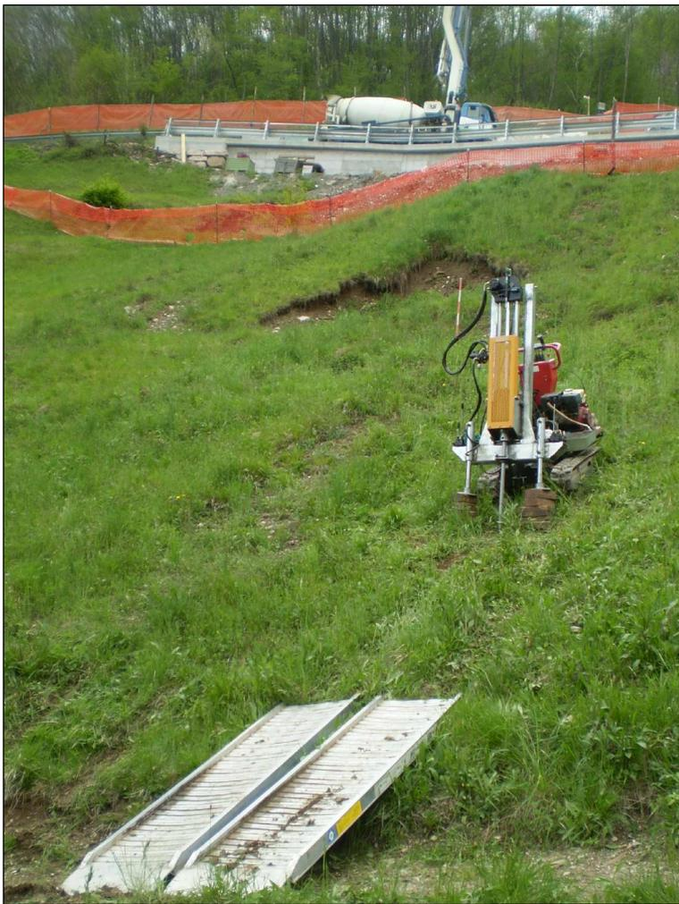
PROVA PENETROMETRICA DINAMICA DIN5
