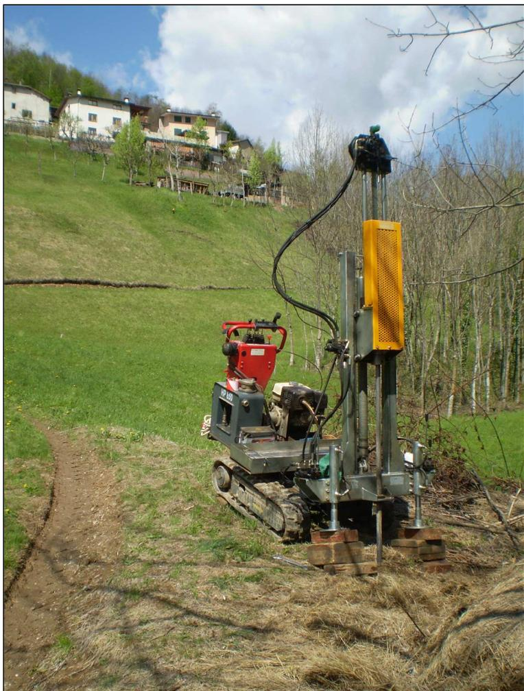
PROVA PENETROMETRICA DINAMICA DIN1
