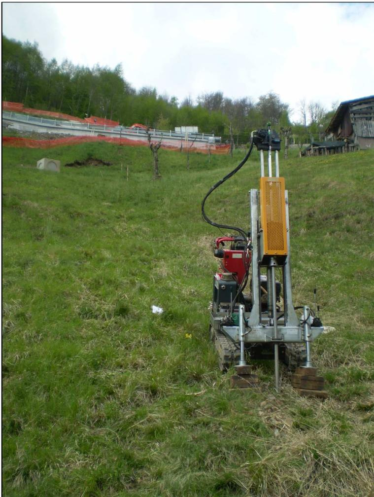
PROVA PENETROMETRICA DINAMICA DIN3
